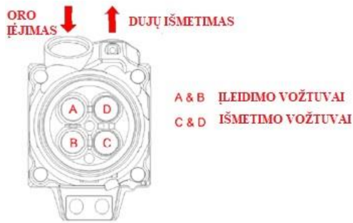
8 pav. Įleidimo ir išmetimo vožtuvų pasiskirstymas
