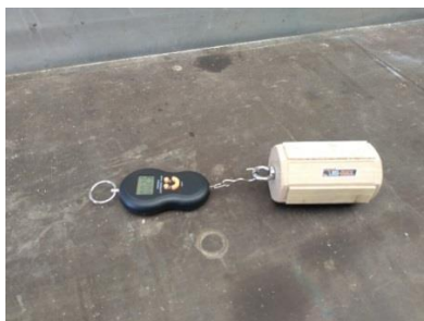
1 pav. Trinties koeficiento matavimas puspriekabėje su prietaisu Lasi – Quick \mu
